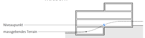
Abbildung 7: Niveaupunkt bei Terrassenhäusern
